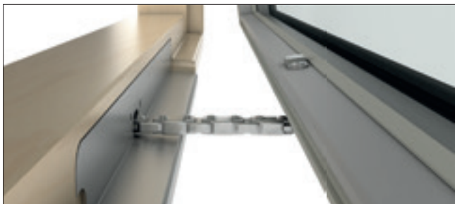
Elektrische Öffnung. Für Dreh-, Kipp-, Senkklappfenster und Terrassentüren erhältlich. Motor wird im Holzrahmen eingefräst. Drei verschiedene Kettenlängen. Benötigt 12-24 Volt Spannungs- versorgung. Geliefert ohne Steuerung und Taster; bitte wenden Sie sich an www.windowmaster.de .
