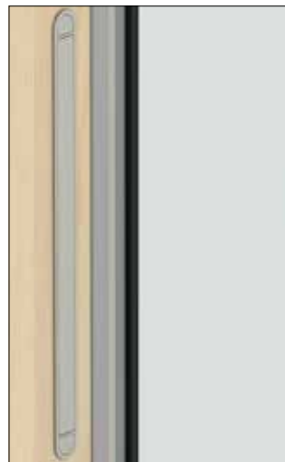
Lüftungsventil. Klickventil mit anodisiertem Oberflächenfinish. Von außen kaum sichtbar. Lüftungsquerschnitt 30cm 2 .
