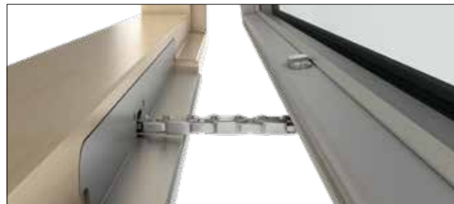
Elektrische Öffnung. Für Dreh-, Kipp-, Senkkloppfenster und Terrassentüren erhältlich. Motor wird im Holzrahmen eingefräst. Drei verschiedene Kettenlängen. Benötigt 12-24 Volt Spannungsversorgung. Geliefert ohne Steuerung und Taster, bitte wenden Sie sich an www.windowmaster.de .
