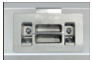
Lüftungsposition. Das Schließblech ermöglicht eine Belüftungsöffnung für alle Paskvilgriffe von 10 mm.
