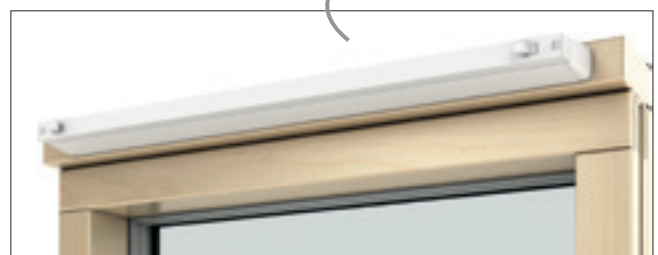
Schallschutzventil. Wird in einer Zuführung eingebaut, die im oberen Rahmen des Fensters montiert wird. Auf der Außenseite ein Aluminiumprofil in der gleichen Farbe wie das Fenster. Das Schallschutzventil hat eine schalldämmende Wirkung von D n,e,w 40 dB.
