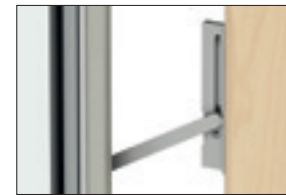
Öffnungsbegrenzer, abschließbar. Darf nicht in Rettungswegfunktion eingesetzt werden. Nicht für Schiebetüren erhältlich. In einer Länge von 160mm und 270mm erhältlich.
